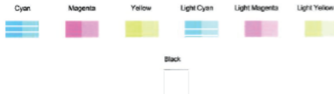
图 9-2 包含缺陷的色块示例
